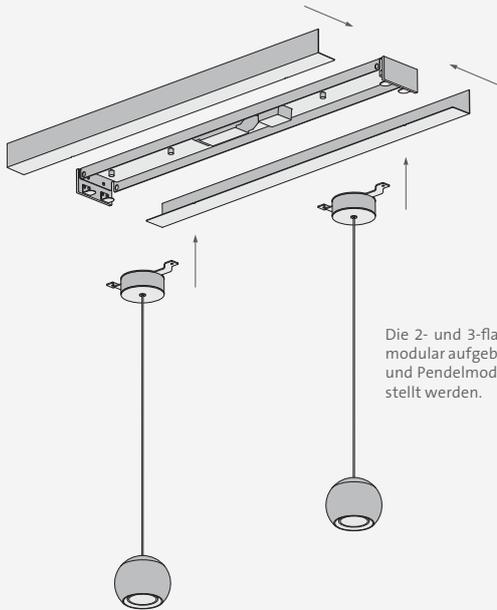
Die 2- und 3-flammigen Leuchten sind modular aufgebaut. Korpus, Abdeckung und Pendelmodule müssen separat bestellt werden.
